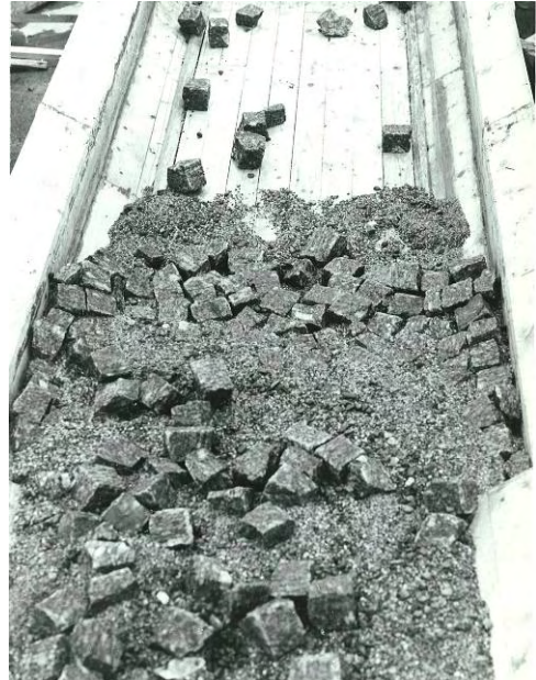
Typisk brudd etter svikt i dekklaget
