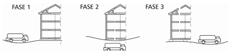
Figur 17.4 Spenningsendring i en konstruksjon når en bølge passerer.
